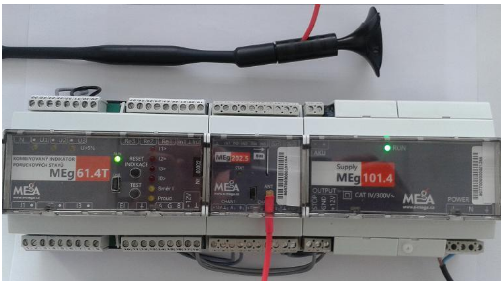
Obrázek 11. Zapojení indikátoru MEG61.4T do sestavy se zdrojem MEG101.4 a komunikační jednotkou MEG202.5
