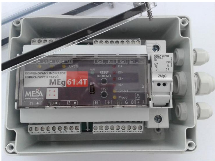
Obrázek 9: Indikátor MEG61.4T v instalační skříňce
