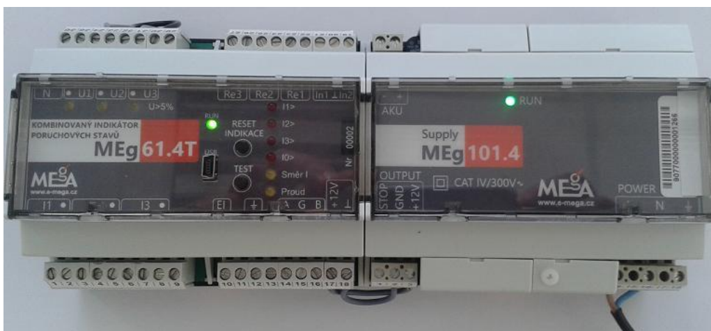
Obrázek 10. Zapojení indikátoru MEG61.4T do sestavy se zdrojem MEG101.4
